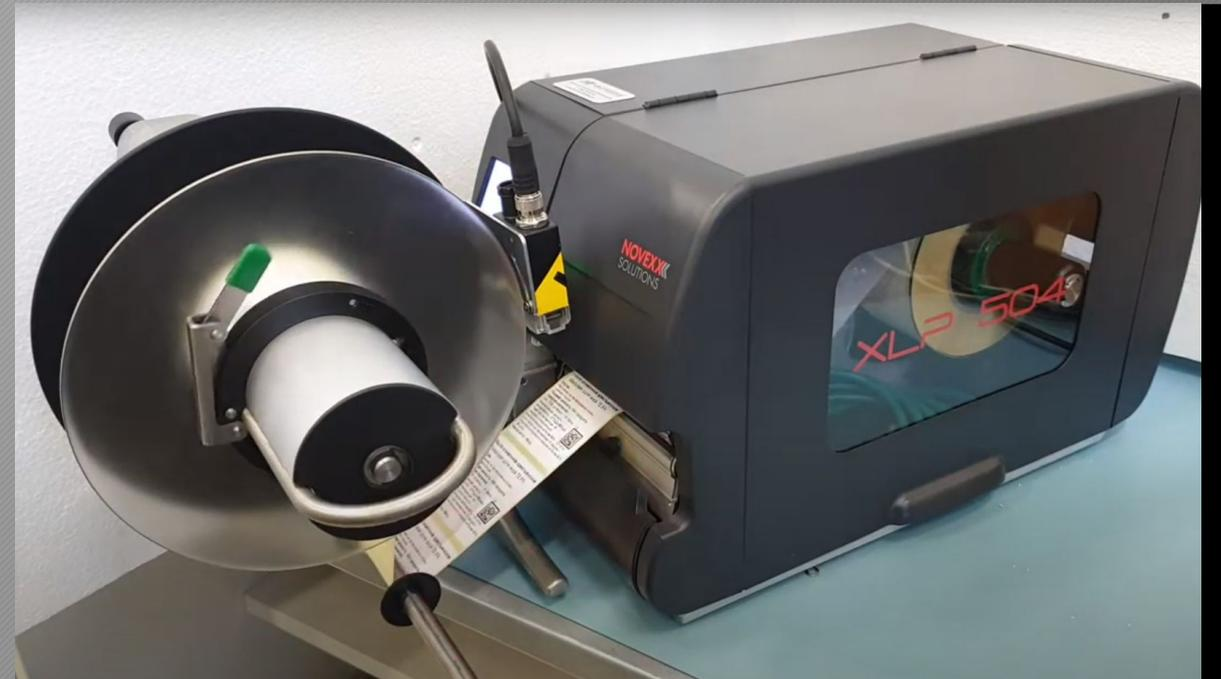
Комплекс предварительной подготовки этикетки с модулем верификации
