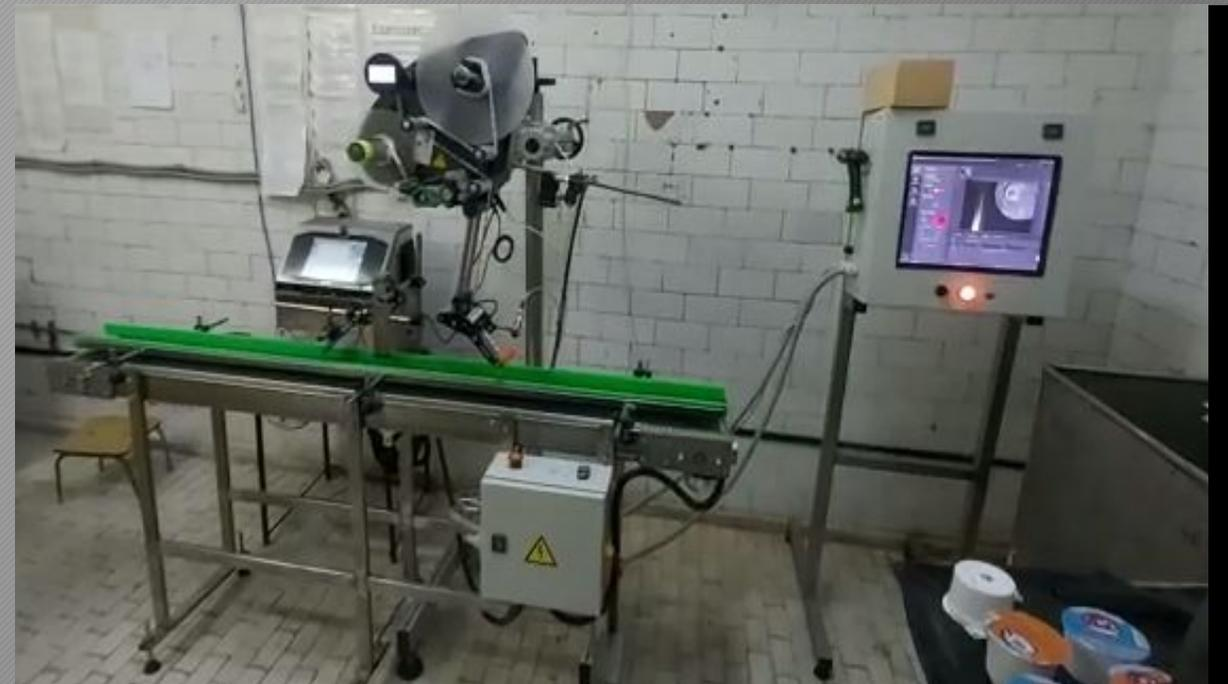
Конвейер с аппликатором, камерой и панелью управления линией
