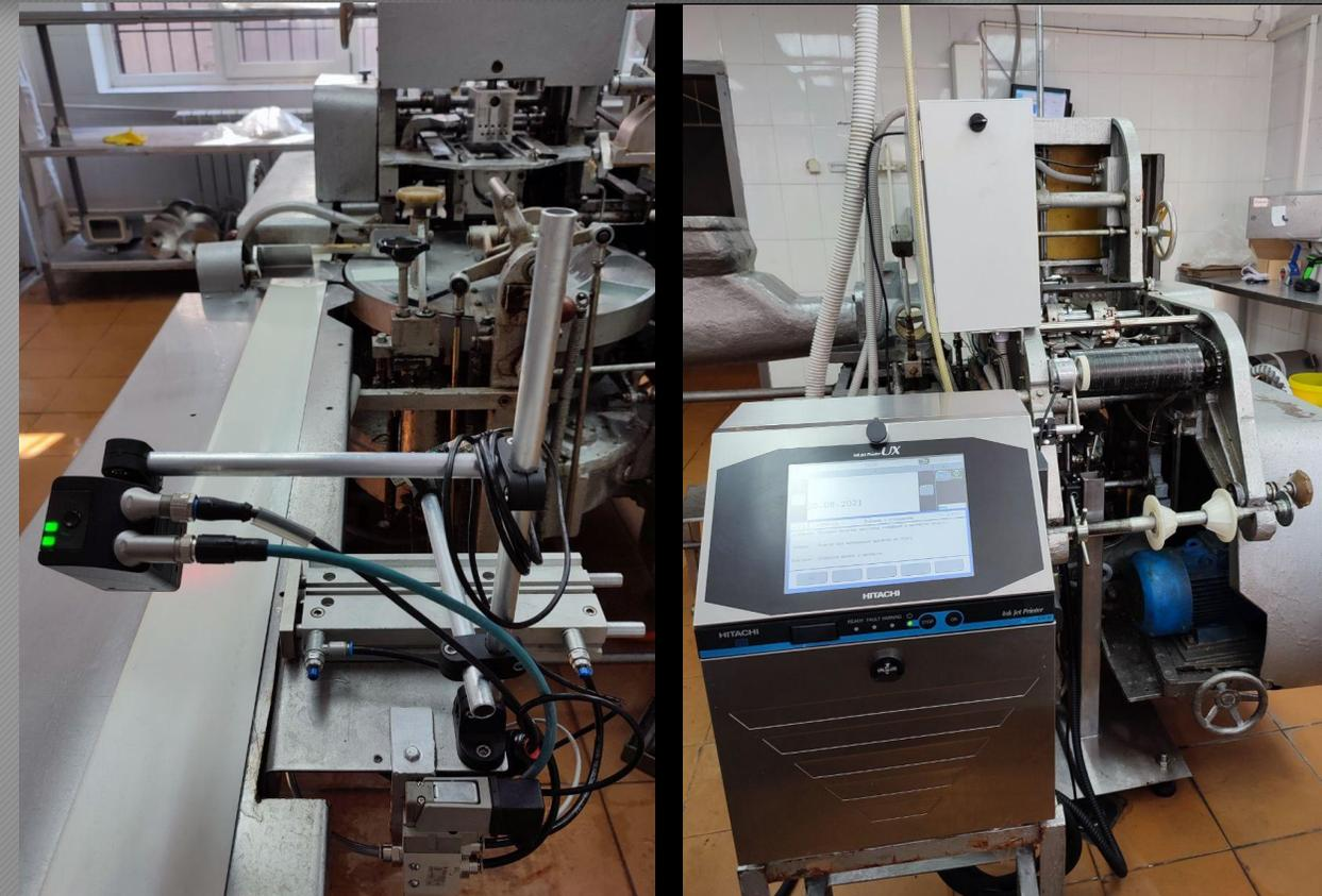
Комплекс маркировки (принтер и камера), установленные на линии фасовки масла
