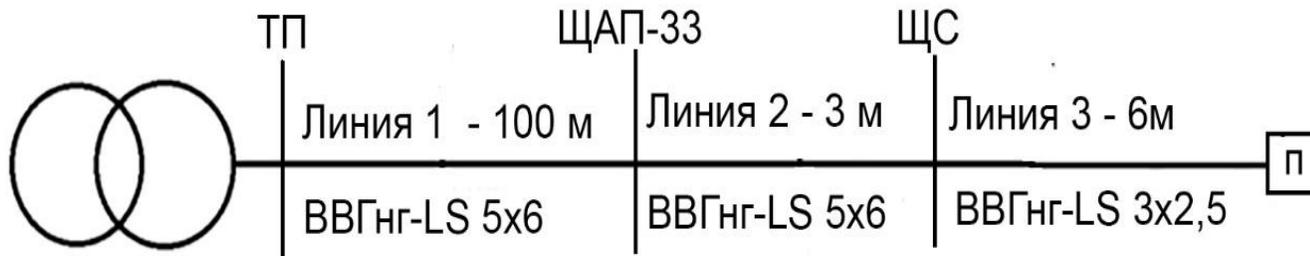
Расчётная схема однофазного тока КЗ для насоса
