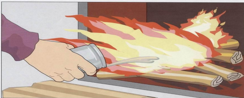
Применение для розжига печей легковоспламеняющихся и горючих жидкостей, выпадение углей, трещины в кладке, возгорание сажи в дымоходах
