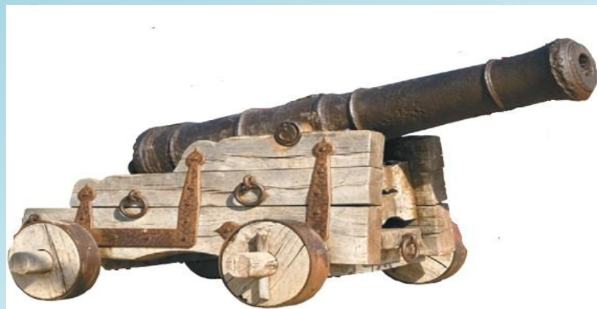
Корабельное орудие, оборудованное железными кольцами. Через кольца продевались корабельные канаты, с помощью которых артиллеристы управляли орудием во время стрельбы
