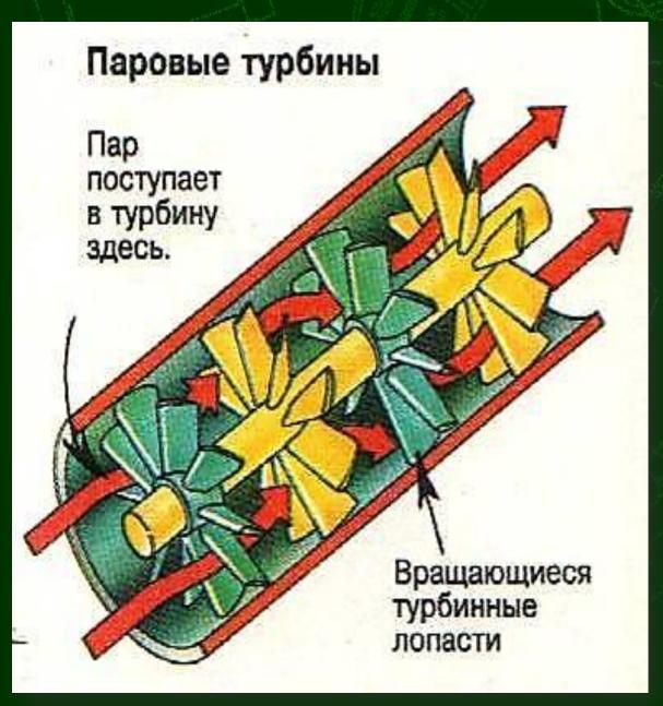
В современной технике широко применяют другой вид теплового двигателя. В нём пар или нагретый до высокой температуры газ вращает вал двигателя без помощи поршня, шатуна и коленчатого вала. Такие двигатели называют паровыми и газовыми турбинами.
