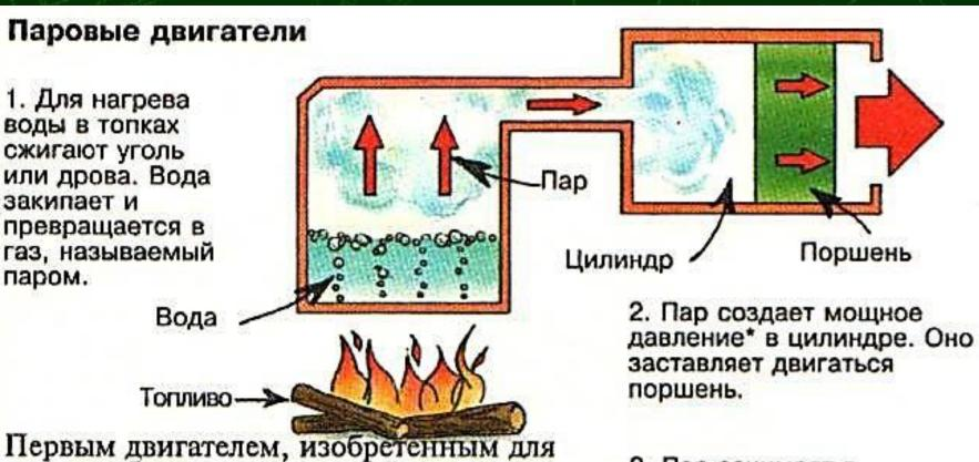
Первым двигателем, изобретенным для того, чтобы приводить в действие машины и механизмы, стал паровой двигатель. Паровые двигатели преобразуют тепло, выделяющееся при сгорании топлива, в энергию движения.
