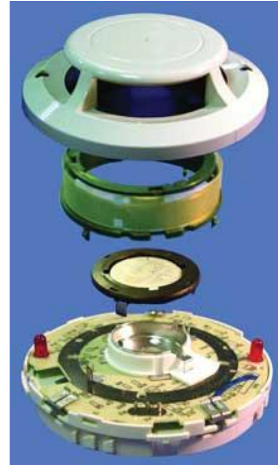
Рис. 11 –Дымовой радиоизотопный извещатель 1151E
