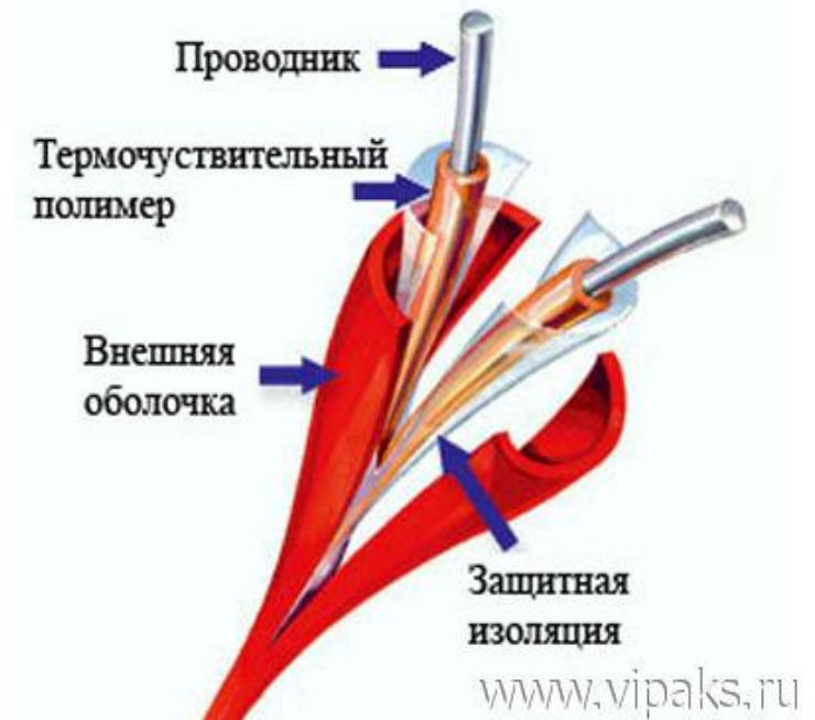
Рис. 4 – Вид термокабеля в разрезе
