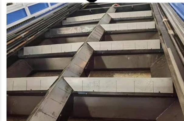
При высокой мощности велик риск деформации стола из-за воздействия тепла, создаваемого лазерным лучом.
