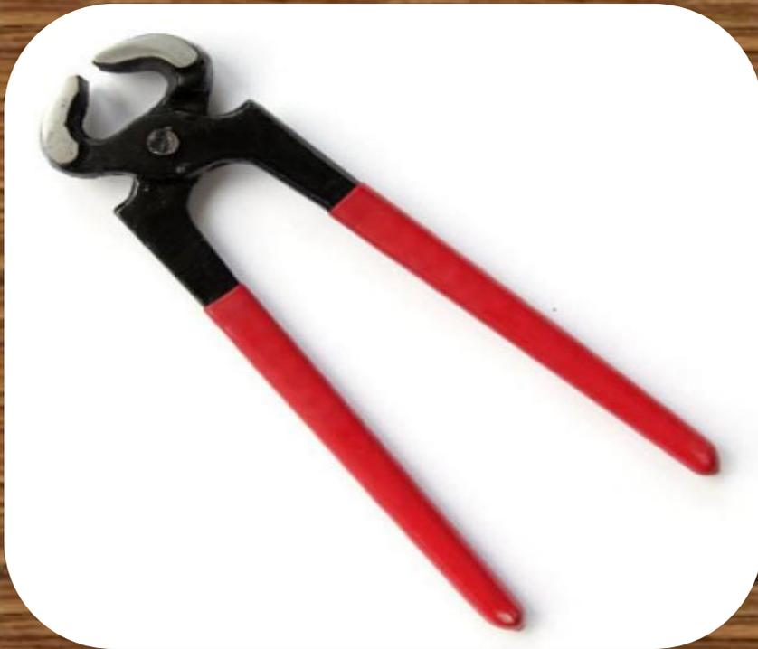
Выделяют столярные клещи, которые используются для вытаскивания вбитых гвоздей и подобных целей, кузнечные клещи для держания раскаленного металла и электроизмерительные клещи.
