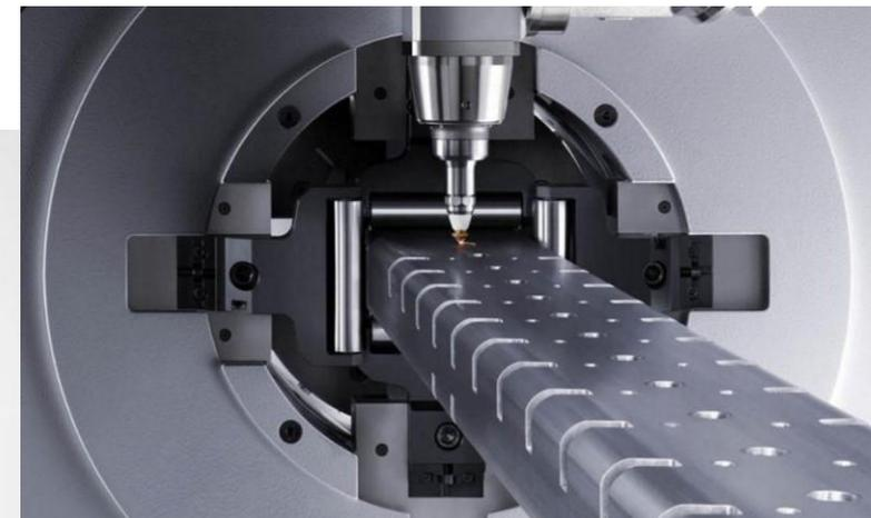
Станок для резки труб оборудован боковым устройством подачи труб, который удобен для загрузки и резки больших труб. Полностью автоматизированный процесс.
