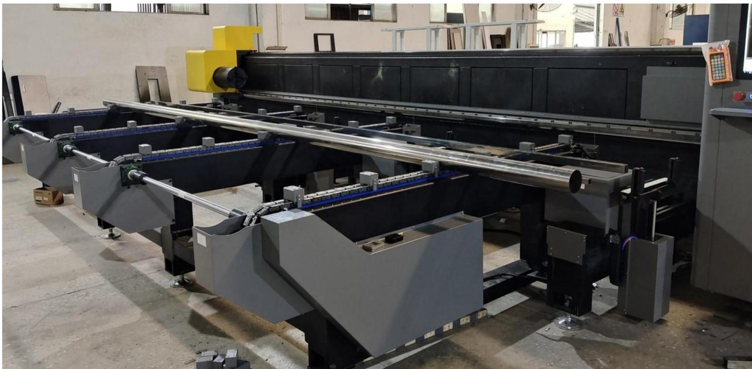
Модель третьего поколения с утолщенной станиной, сервоприводом и подключением к шине является более стабильной и точной, чем модель второго поколения.
