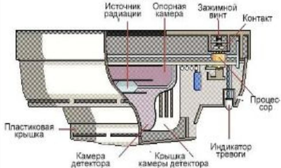
Принцип действия ионизационного детектора дыма
