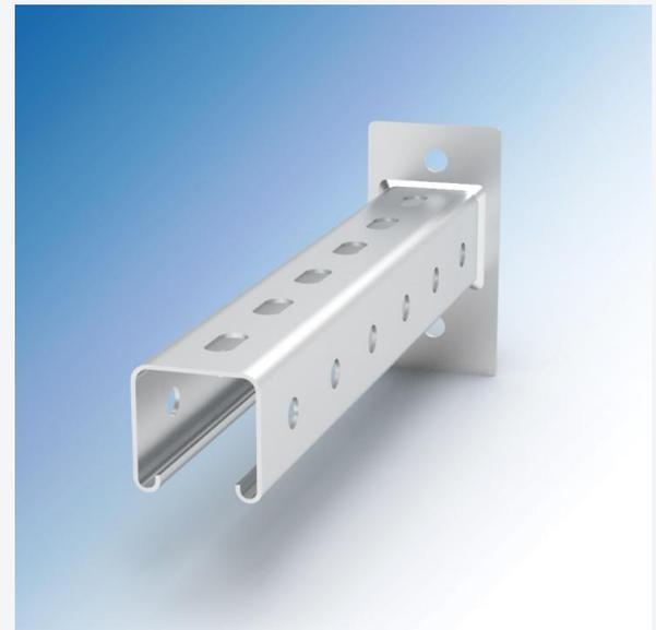
Стойка STRUT — универсальный опорный монтажный элемент, фиксирующий консольные кронштейны и траверсы. Используется для монтажа инженерных систем и кабельных трасс по стенам, полу и потолку. Все страт-консоли изготовлены из профиля 41x41, 41x21, бывают так же двойные стойки. Толщина: 2,5мм, 2 мм, 1,5мм. Опорная площадка 120x120 мм
