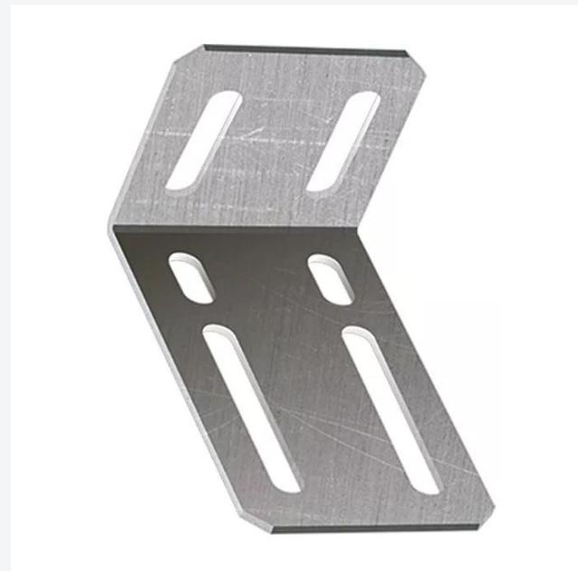
Страт-консоль предназначена для прокладки КНС (кабеленесущих систем), вентиляции инженерных коммуникаций, освещения и прочего. Все страт-консоли изготовлены из профиля 41x41, толщиной 2,5мм. Под заказ мы можем изготовить страт-консоли толщиной 2 мм.
