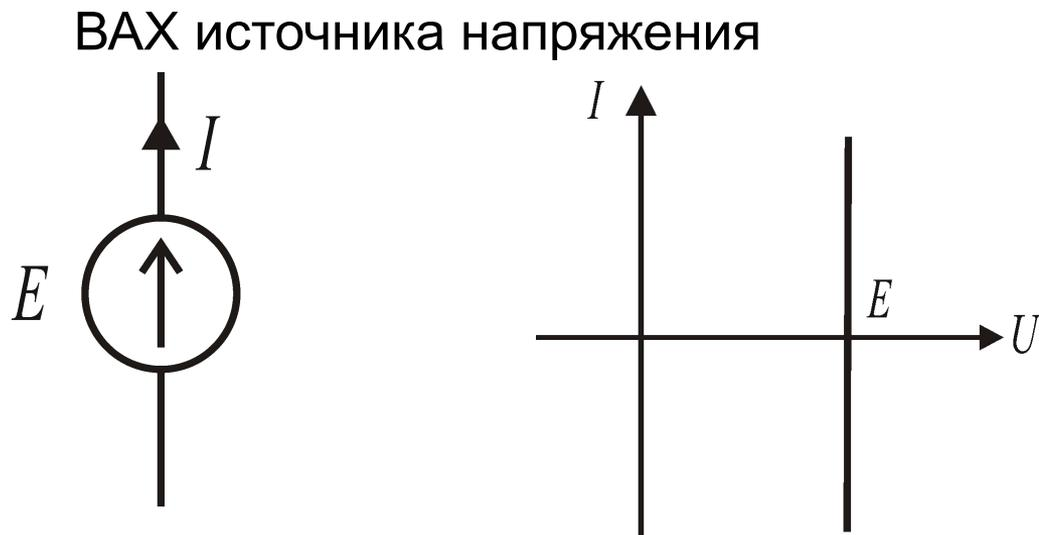
Внутреннее сопротивление идеального источника напряжения равно нулю.
