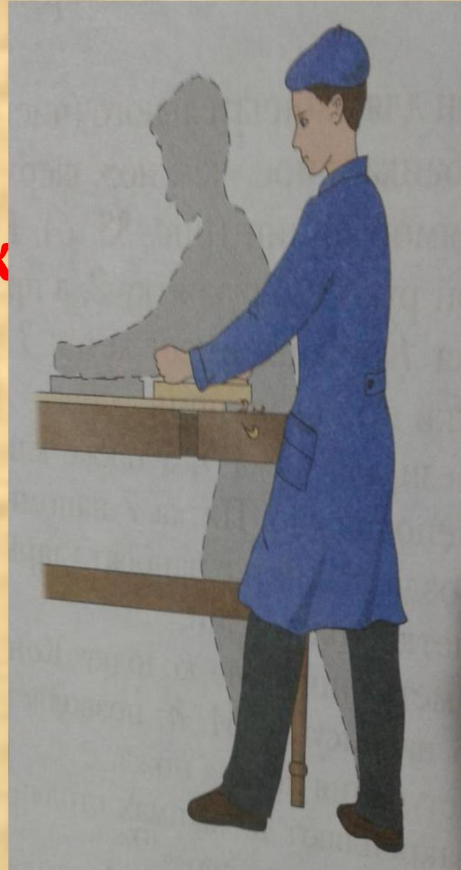
Строгание заготовок из древесины применяют для того, чтобы будущей детали форму и размеры, указанные в чертеже. При строгании с поверхности заготовки снимается тонкий слой древесины – стружка, что позволяет получить ровные и гладкие поверхности.
