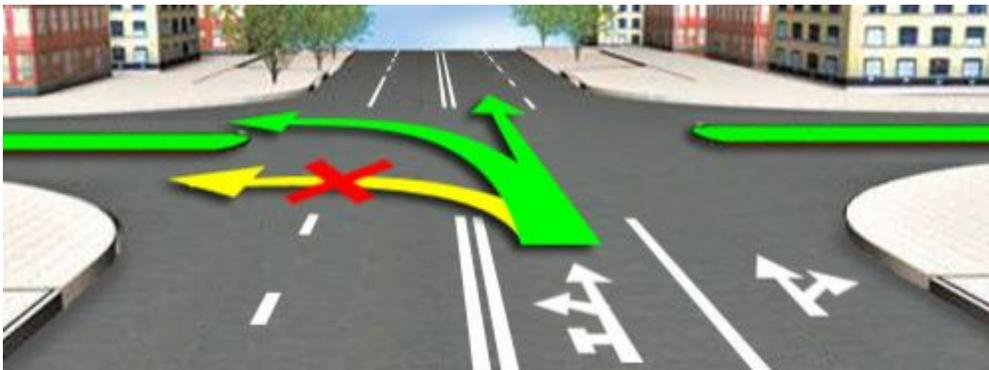
Отдельного разговора заслуживает разметка с изображением тупичка. Такую разметку применяют в тех случаях, когда пересекаемая дорога оборудована разделительной полосой и необходимо указать водителям, что **поворот** на ближайшую проезжую часть **запрещён**.
