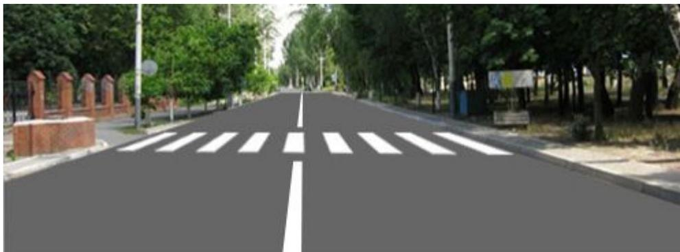
Если ширина перехода не более 6 метров на проезжей части наносят простую «зебру» - Разметка 1.14.1.
