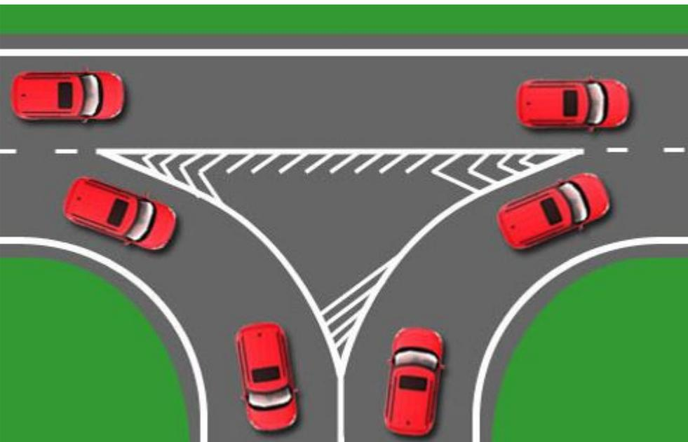
**Точно также и всевозможные направляющие островки наносятся на проезжую часть с использованием линий 1.1. Однако здесь Правила всё же решили присвоить номера, только не самим островкам, а различным вариантам внутренней штриховки островков.**
