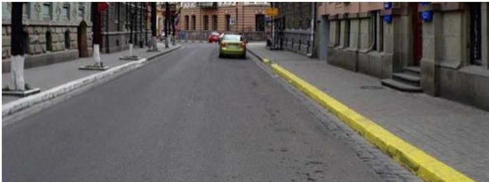
Правила также разрешают наносить сплошную жёлтую линию не только по краю проезжей части, но и по бордюру. В данной ситуации для водителей тоже ничего не изменилось – по-прежнему остановка **запрещена** на всём протяжении этой жёлтой линии.
