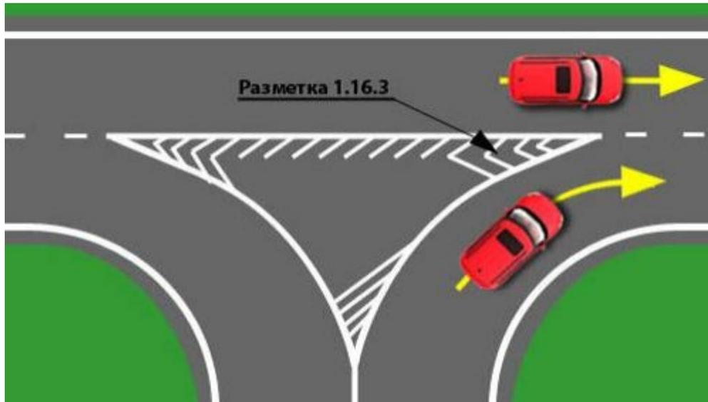
Разметка 1.16.3 наносится в местах слияния транспортных потоков попутных направлений.
