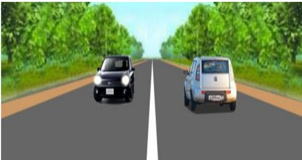
**Организация дорожного движения началась с деления проезжей части между встречными потоками транспорта. Самым простым решением было провести сплошную продольную линию разметки строго посередине проезжей части. Такую разметку еще называют «осевой линией».**
