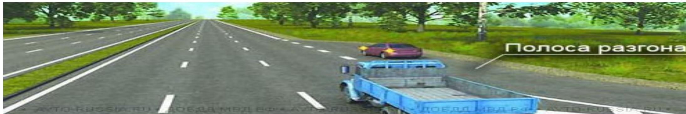
Линия **1.8** (Широкая прерывистая линия) — обозначает границу между полосой разгона или торможения и основной полосой проезжей части; Линию **1.8** —пересекать **разрешается** с любой стороны.
