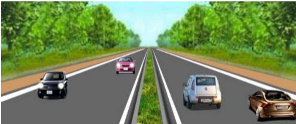
Ещё надёжнее можно разделить встречные транспортные потоки, если посередине проезжей части соорудить разделительную полосу. В этом случае на дороге тоже будет четыре сплошных линии, только теперь все эти линии это одна и та же разметка – Разметка 1.2, показывающая водителям границы проезжей части данного направления.
