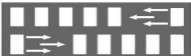
**Разметка 1.14.2** (тоже «зебра») – и тоже обозначает пешеходный переход. Наносится на проезжую часть в тех случаях, когда ширина зоны перехода превышает 6 метров.
