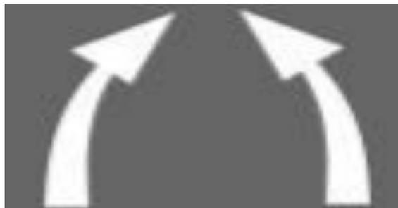
Разметка 1.19 (плавно изогнутые стрелы) – предупреждает о приближении к сужению проезжей части или к участку дороги, где уменьшается количество полос движения данного направления. Разметку 1.19 также применяют для предупреждения о приближении к сплошной или комбинированной осевой линии, разделяющей транспортные потоки встречных направлений.
