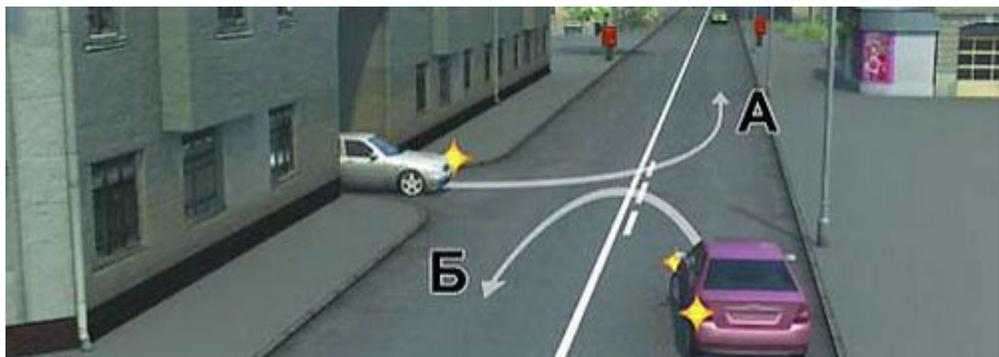
**Вот пример использования комбинированной линии разметки. Каждому грамотному водителю понятно где здесь въезд на заправку, а где выезд. Но самое важное применение такой разметки – это использование её в качестве осевой линии, разделяющей встречные транспортные потоки на двухполосных дорогах. Для чего это делается? Для того чтобы разрешить водителям обгоны и объезды поочерёдно в обоих направлениях.**
