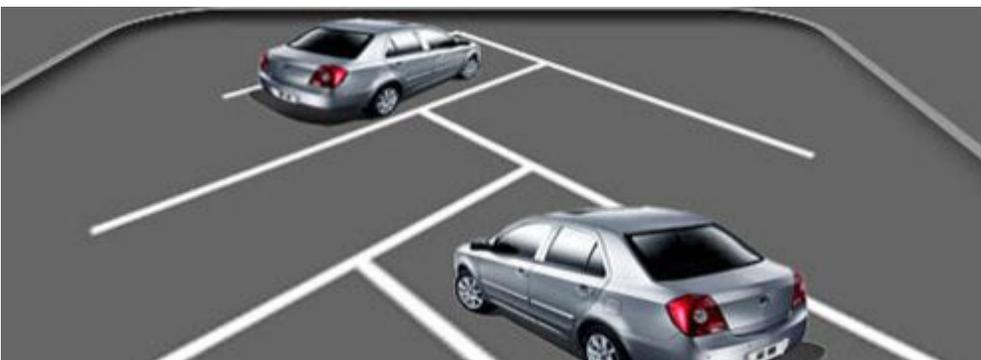
**Если для стоянки транспорта выделена специальная площадка, то там стояночные места могут быть размечены и другими способами. Например, вот так под углом друг к другу, но это опять сделано с использованием сплошных белых линий, то есть с помощью линий 1.1. Для разметок стояночных мест Правила вообще не предложили никакой отдельной нумерации, любая конфигурация мест, предназначенных для стоянки транспорта, размечается с помощью линий 1.1**
