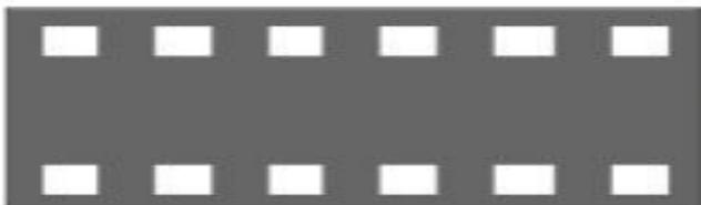
**Разметка 1.15** (две прерывистые поперечные линии с квадратными штрихами и квадратными промежутками) – обозначает место, где велосипедная дорожка пересекает проезжую часть.
