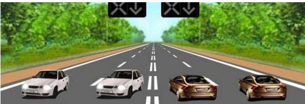
Если реверсивные светофоры сломаны или отключены, водители должны располагать свои транспортные средства так, как если бы осевая линия была сдвоенной сплошной. То есть так же, как на обычной многополосной дороге.
