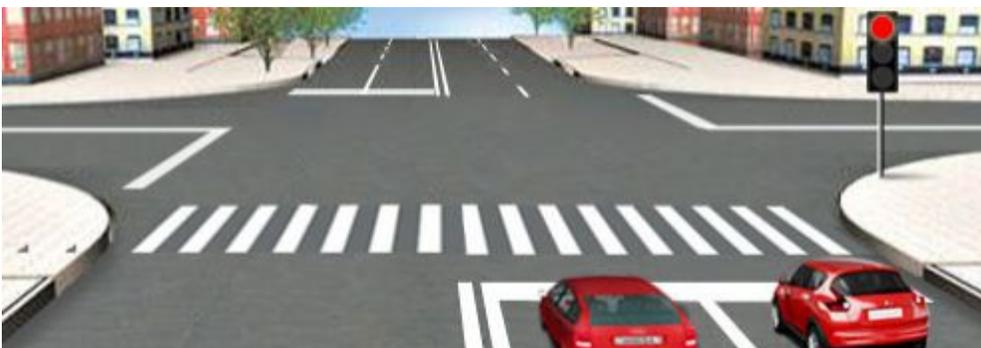
На регулируемом перекрёстке стоп-линия может быть нанесена за несколько метров до пересекаемой проезжей части для того, чтобы водители, остановившись, хорошо видели сигналы светофора. А если на проезжей части нанесена «зебра», тогда логично нанести стоп-линию до «зебры».
