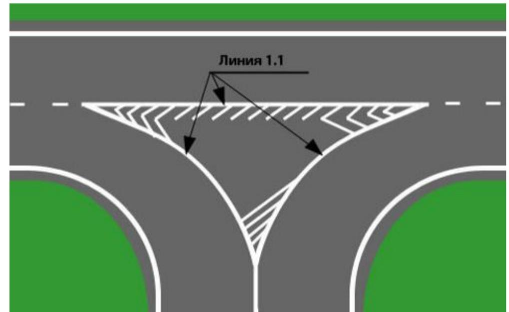
Разметка [1.16.1](#) - обозначает островки, разделяющие транспортные потоки противоположных направлений, а также места для стоянки транспортных средств (парковки) и велосипедные полосы;
