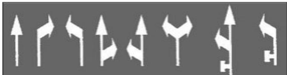
Разметка 1.18 – указывает **разрешённые** на перекрёстке направления движения по полосам. Применяется самостоятельно или в сочетании со знаками «Направление движения по полосам».
