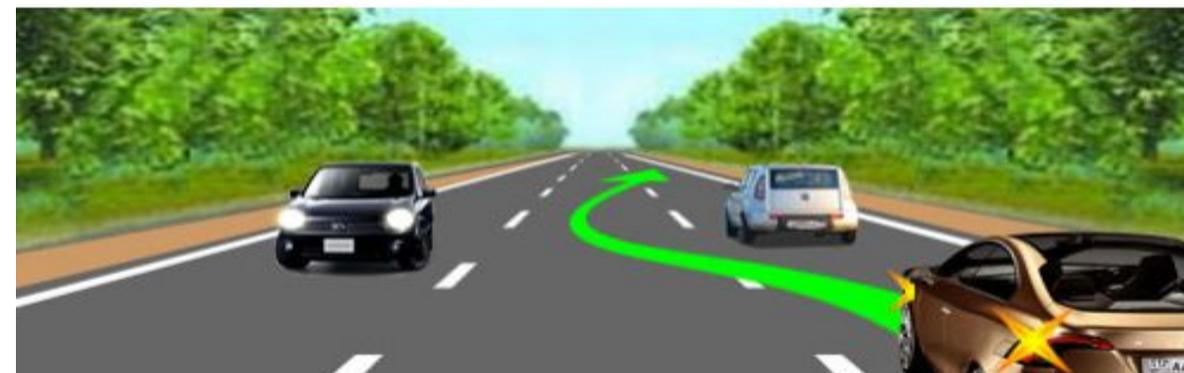
С помощью этой же прерывистой линии дорогу можно разбить на три полосы, позволив водителям обоих направлений выезжать на среднюю полосу во время обгона или объезда.
