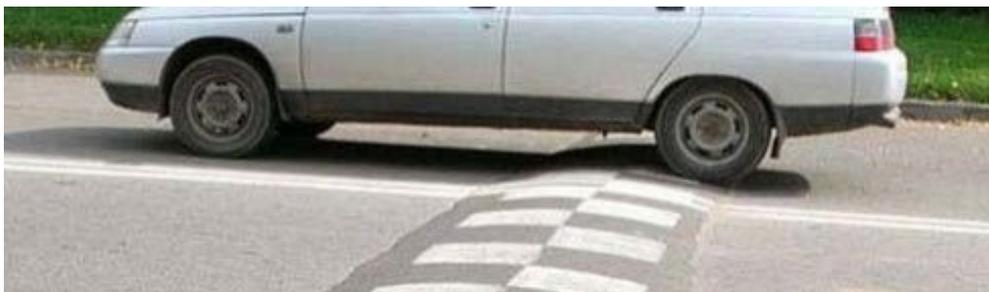
**Также поперёк дороги может располагаться искусственная неровность («лежачий полицейский») – эффективное средство для принудительного снижения скорости движения транспорта. Если есть возможность, эту шашечную поперечную разметку наносят непосредственно на искусственную неровность.**
