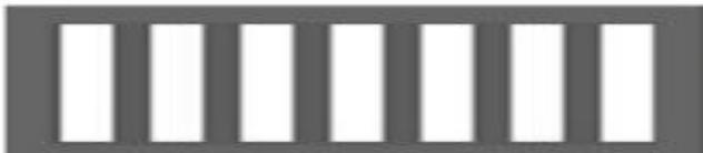
**Разметка 1.14.1** («зебра») – обозначает пешеходный переход. Наносится на проезжую часть в тех случаях, когда ширина зоны перехода не превышает 6 метров.
