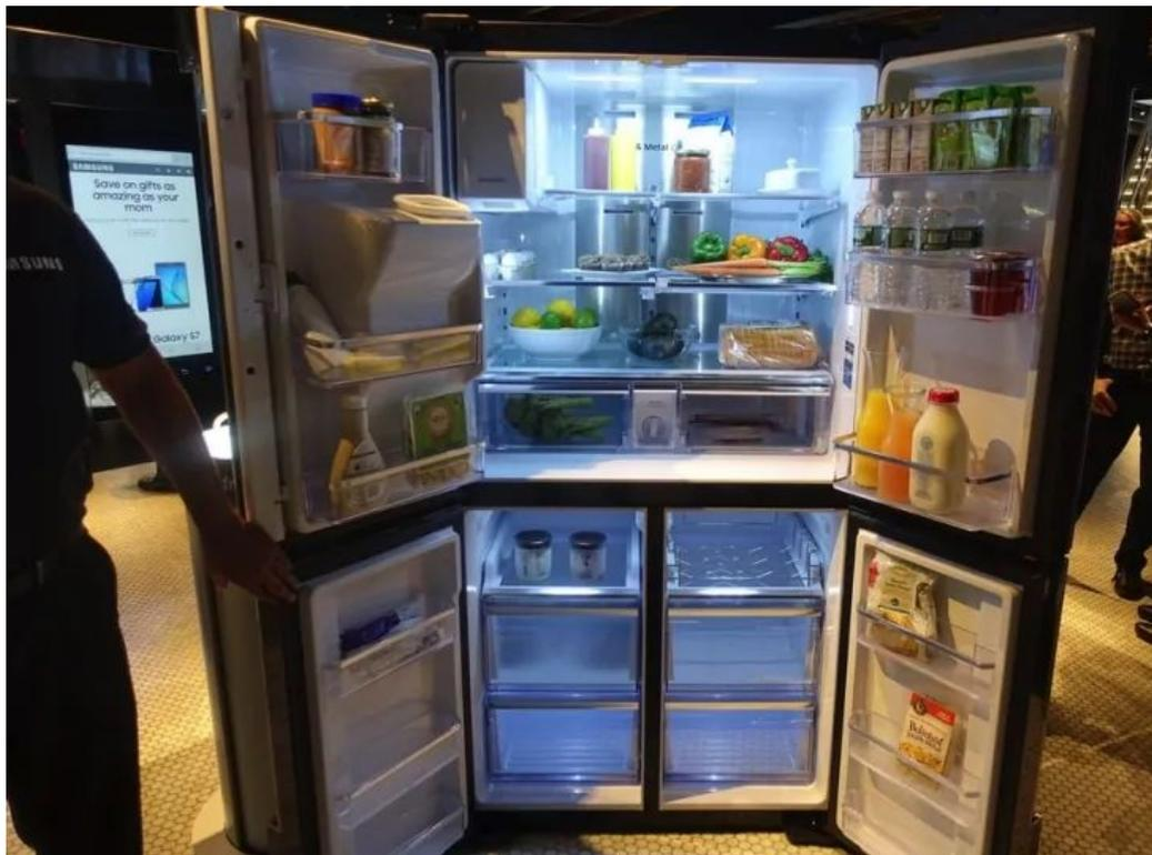
Где бы ни находился хозяин холодильника, он сможет контролировать его содержимое посредством смартфона. Это возможно благодаря трем камерам, находящимся внутри. Каждое закрытие двери активизирует их, и они делают снимки.
