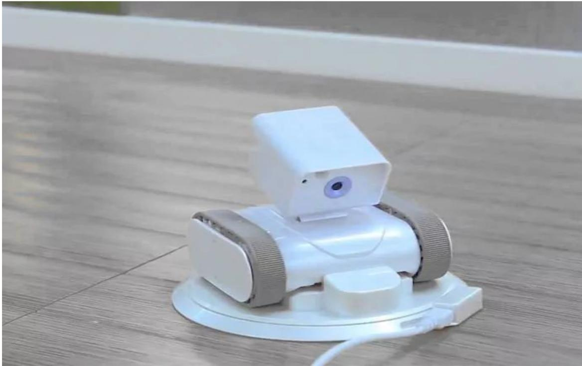
Робот делает снимки в цвете, записывает видео высокой четкости. Может включать видеосвязь. Ночное видео обеспечивается посредством светодиода.
