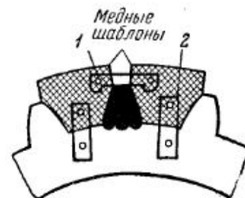
Рис. 118. Наплавка зуба по медным шаблонам
