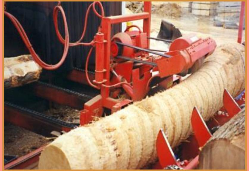
До ворот цеха плывут брёвна по реке или их везут в специальных вагонах. А здесь за дело берутся другие машины: многопильный станок распиливает брёвна на чурбаки, а машина-корообдирка сдирает с них кору.
