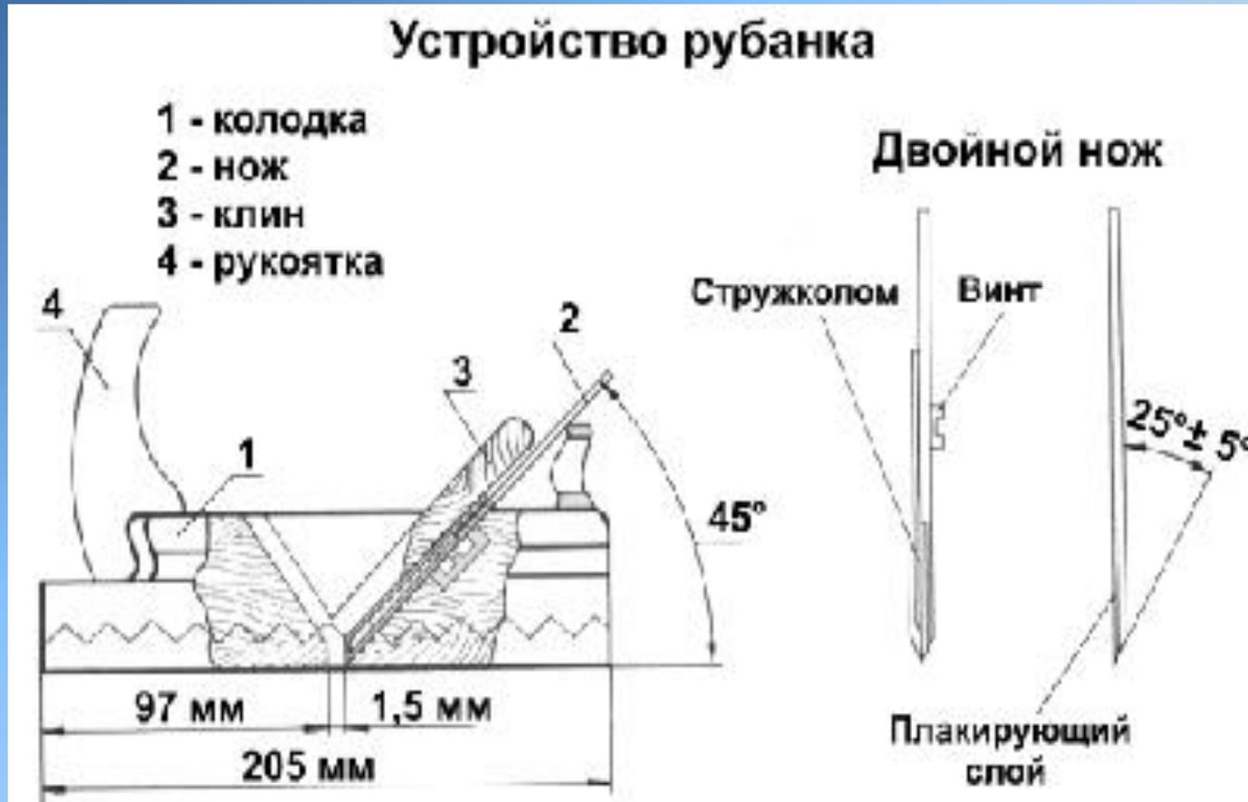
Рубанок предназначен для сострагивания тонких стружек и получения гладких поверхностей на древесине, а также сострагивания заготовки в нужный размер.
