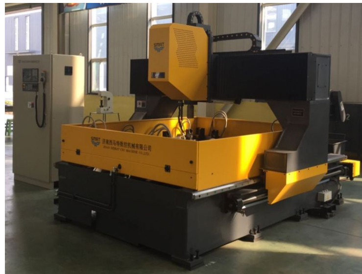
Координатно- сверлильный станок PD2016 Максимальный размер заготовки: 2,0×1,6м
