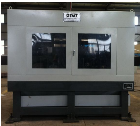
Затыловочная машина для уголка TQC200-2C Размеры: 2,2*1.5*1.66м
