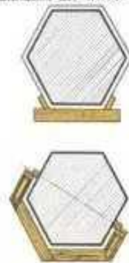
ВЫГИБАНИЕ ШЕСТИГРАННОЙ КОЛОННЫ
