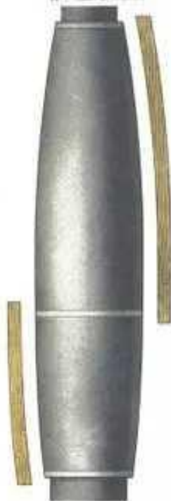
ОШТУКАТУРОВАНИЕ КОЛОННЫ С ДРОНЫМ ЭНТАЗИСОМ
