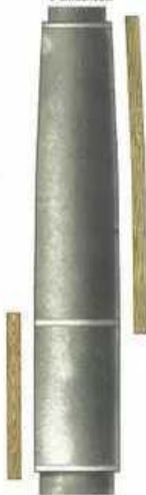
ОШТУКАТУРОВАНИЕ КОЛОННЫ С ЭНТАЗИСОМ
