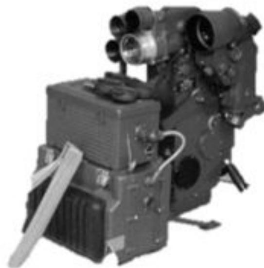
Переносной лазерный прибор оптико-электронного противодействия «ПАПВ»
