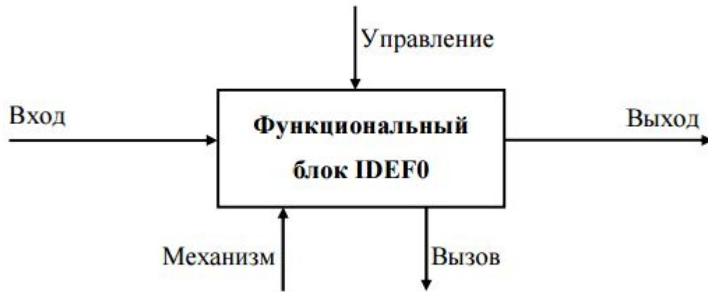
Каждая сторона блока имеет определенное назначение. Левая сторона предназначена для входов, верхняя – для управления, правая – для выходов, нижняя – для механизмов и вызовов [1, 11, 12].
