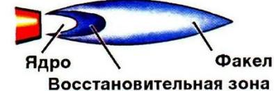
Ядро конусообразное, укороченное, имеет менее резкие очертания, бледнеет. Пламя - синевато-фиолетовое, горит с шумом. Все зоны сокращаются по длине. Окисляет металл. Шов получается хрупким и пористым. Используют при сварке латуни
