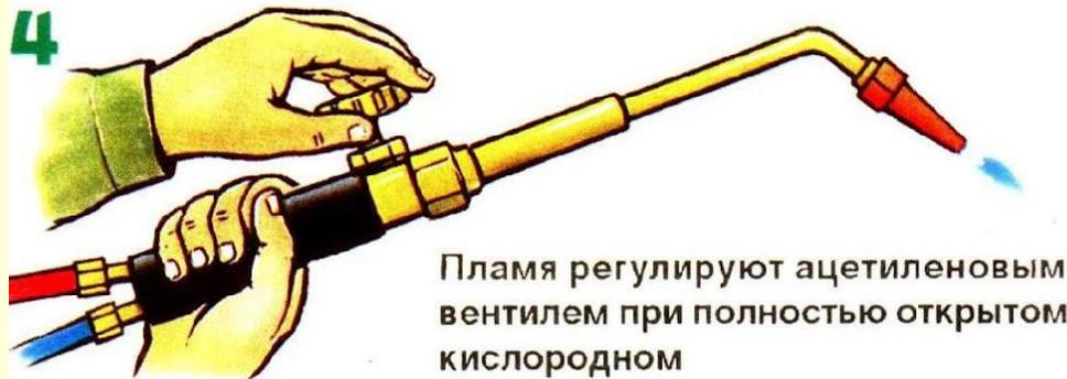
Пламя регулируют ацетиленовым вентилем при полностью открытом кислородном
