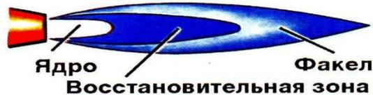
Ядро - резко очерченное, цилиндрической формы с плавным закруглением, ярко светящейся оболочкой, четко выражены все три зоны. Используют для сварки большинства сталей, сплавов и цветных металлов
