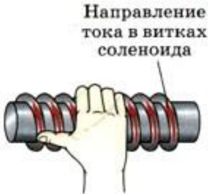
**Зная направление тока в соленоиде, по правилу правой руки можно определить направление магнитных линий поля внутри него, а значит, и его магнитные полюсы.**
