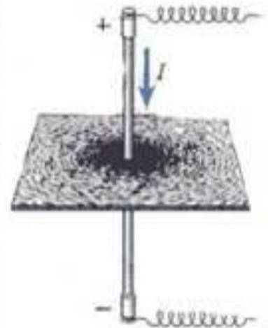
**Под действием магнитного поля тока магнитные стрелки или железные опилки располагаются по concentрическим окружностям**
