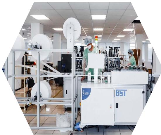
На производстве FAROS Protection функционируют **5 линий** для изготовления медицинских и гигиенических масок, которые выпускают до 8-9 млн. масок в месяц.
