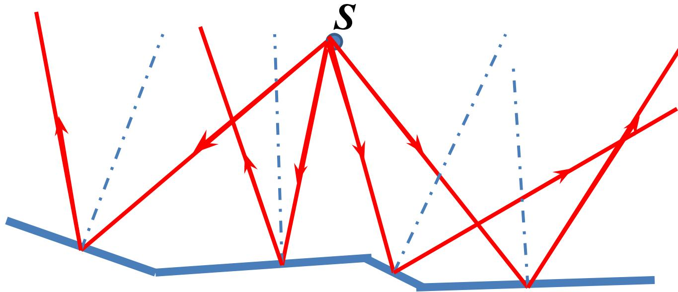
Отраженные от шероховатой поверхности лучи направлены случайным образом.
