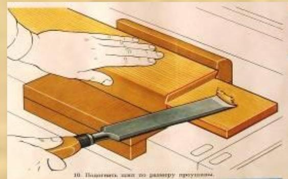
Очень часто ученики допускают неточности и ошибки при выполнение запиливания шипов и проушина. Необходимо внимательно следить - где должно проходить полотно пилы при запиливании.
