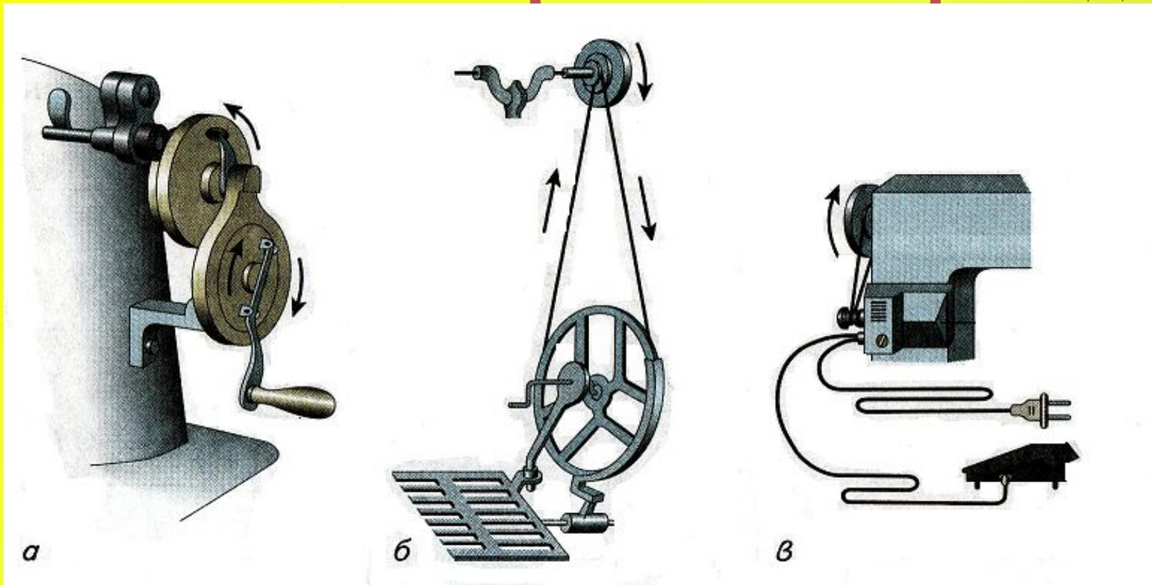
*а)ручной привод; б)ножной привод; в)электрический привод;*
