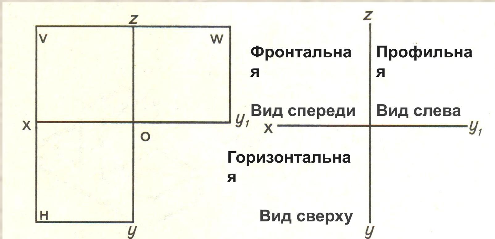
Чертеж, представленный тремя проекциями или видами, дает наиболее полное представление о форме и конструкции предмета и называется **КОМПЛЕКСНЫМ ЧЕРТЕЖОМ**
