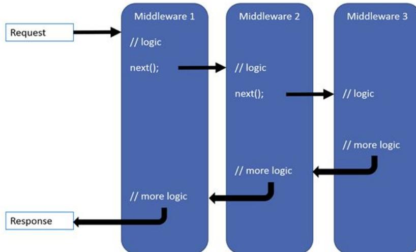
Метод `Configure` выполняется один раз при создании объекта класса `Startup`, и компоненты `middleware` создаются один раз и живут в течение всего жизненного цикла приложения. То есть для последующей обработки запросов используются одни и те же компоненты.
