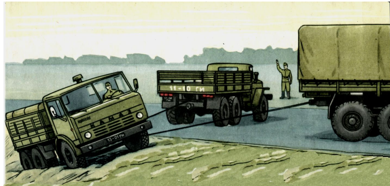
Вытаскивание автомобиля которому грозит опрокидывание
