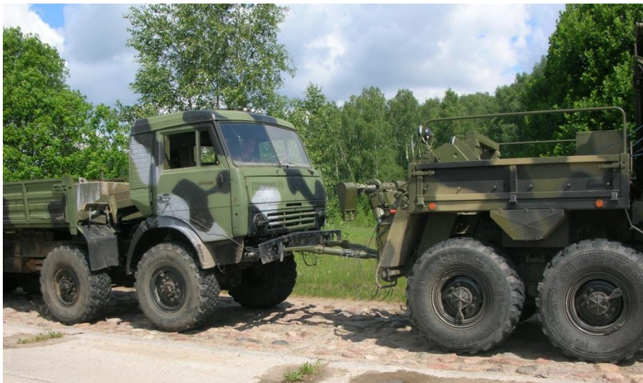
Транспортирование автомобиля с использованием двойного жёсткого буксира.
