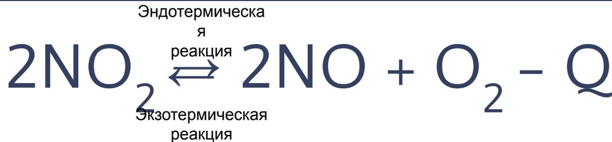
**При понижении температуры** система отвечает нагреванием, т.е. смещением равновесия в сторону экзотермической реакции соединения NO и O<sub>2</sub>.
