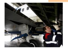
Агрегаты (блоки и детали), поступившие со складов и баз, для определения их исправности перед установкой на ВС обязательно осматриваются и проверяются в ТЭЧ части
