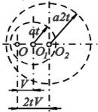
При движении точечного источника возмущений с дозвуковой скоростью  $V < a$  сферические волны смещаются в сторону движения источника, но опережают его, т.е. источник находится внутри вызванной им сферической волны.
