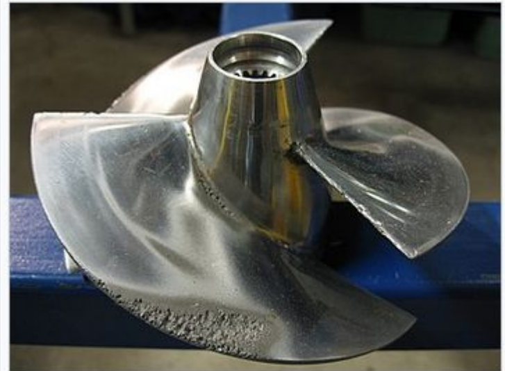
Кавитационные повреждения гребного винта
