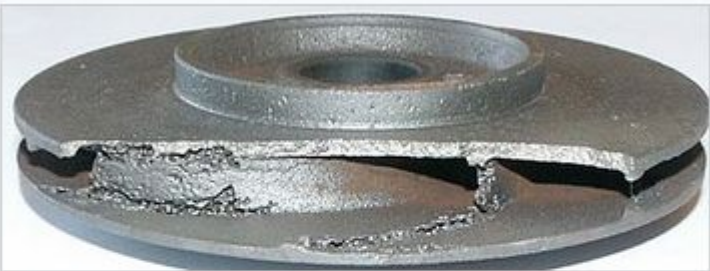
Повреждения, наносимые эффектом кавитации (часть насоса)
