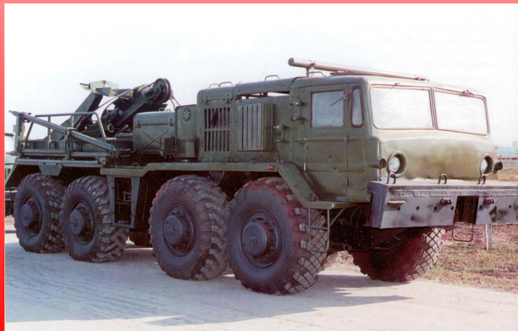
Тяжелый колёсный эвакуационный тягач КЭТ-Т (ТК-7)
