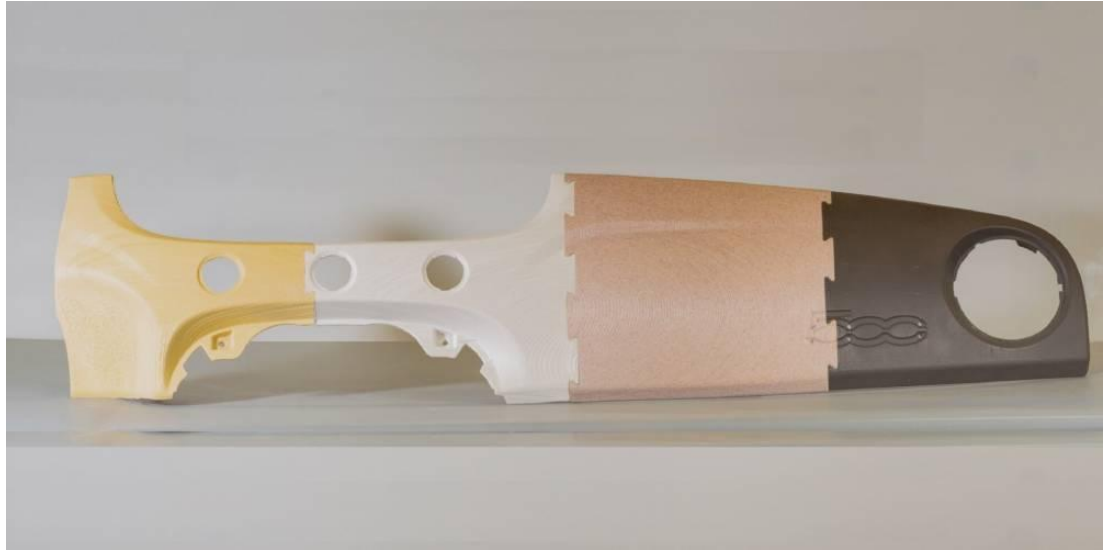
Приборная панель Fiat 500 из цедры лимона, скорлупы миндаля и кожуры граната
