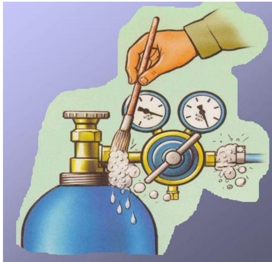
Проверяют герметичность соединений
