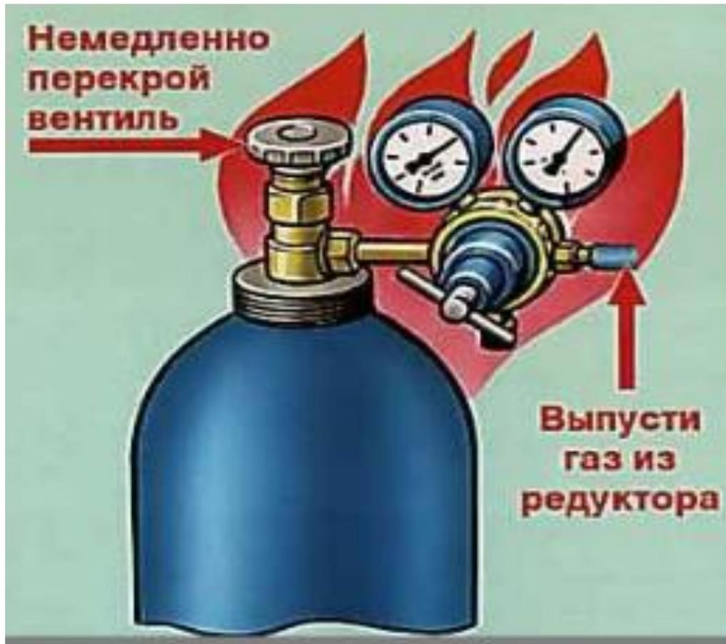
В случае самовозгорания редуктора следует быстро закрыть вентиль кислородного баллона рукой, защищенной брезентовой рукавицей или вачегом.
