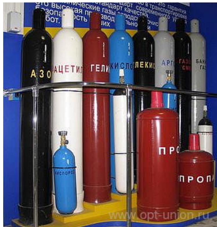
Баллоны представляют собой стальные цилиндрические сосуды, в горловине которых имеется конусное отверстие с резьбой, куда ввертывается запорный вентиль.
