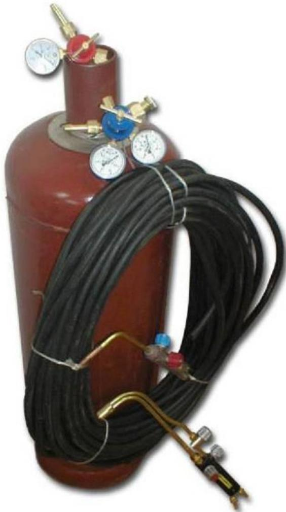
К одному жидкостному затвору, сухому затвору или обратному клапану может быть присоединен только один резак. Если газоразборный пост питает машину, обслуживаемую одним оператором, то количество горелок или резак, устанавливаемых на машине, ограничивается только пропускной способностью затвора или клапана.
