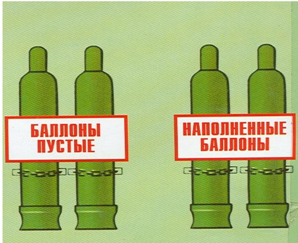
Пустые баллоны следует хранить отдельно от баллонов, наполненных газом. При обращении с пустыми баллонами из под кислорода и горючих газов должны соблюдаться такие же меры безопасности, как и при обращении с наполненными.
