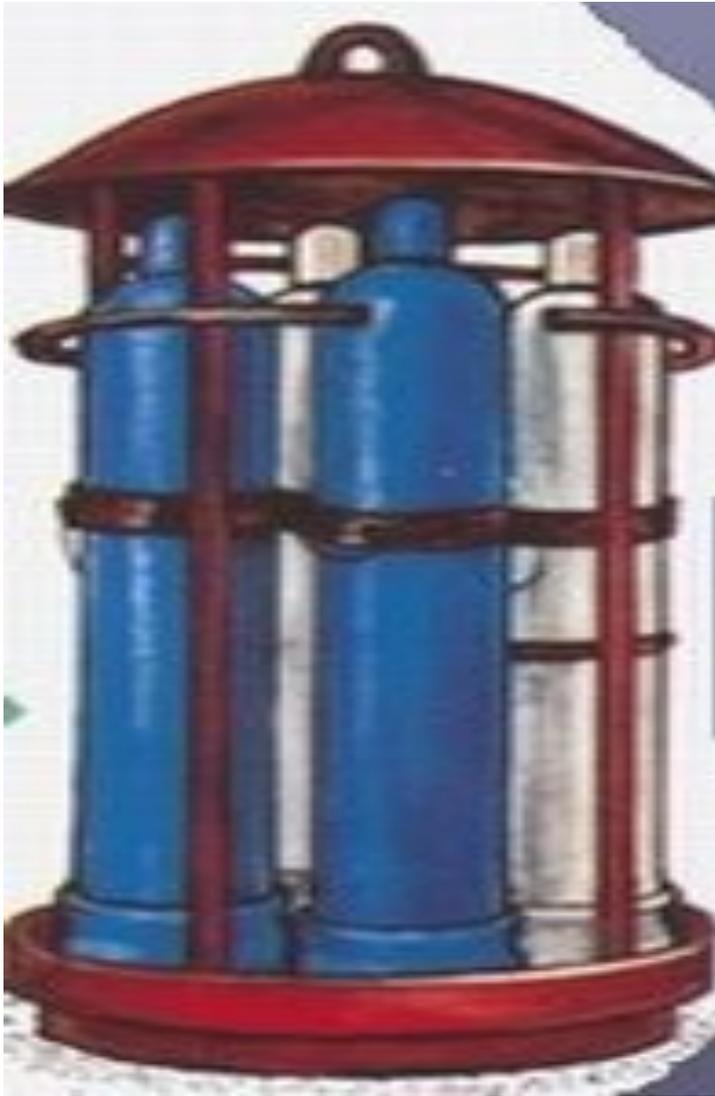
Разрешается перевозка баллонов в специальных контейнерах, а также без контейнеров в вертикальном положении обязательно с прокладками между ними и ограждением от возможного падения. При погрузке, разгрузке, транспортировании и хранении баллонов должны приниматься меры, предотвращающие падение, повреждение и загрязнение баллонов.
