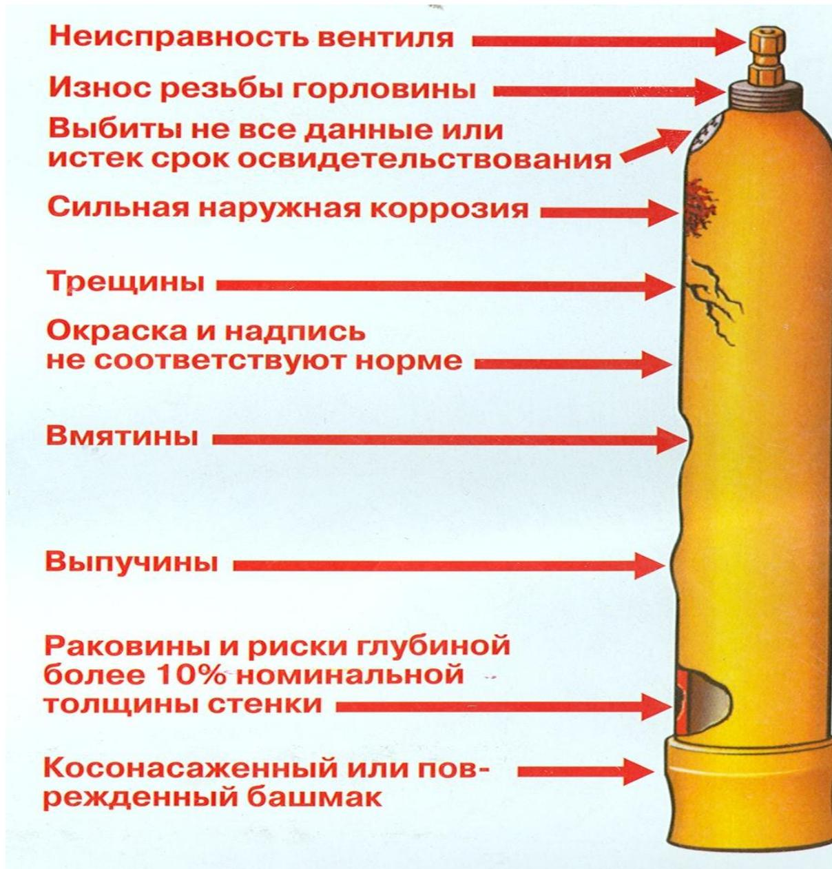
Баллоны должны возвращаться на склад или завод для заполнения с заглушками, колпаками и закрытыми вентилями при наличии остаточного давления газа. Остаточное давление в баллонах для кислорода и других горючих газов должно быть не ниже 0,049 МПа (0,5 бар).
