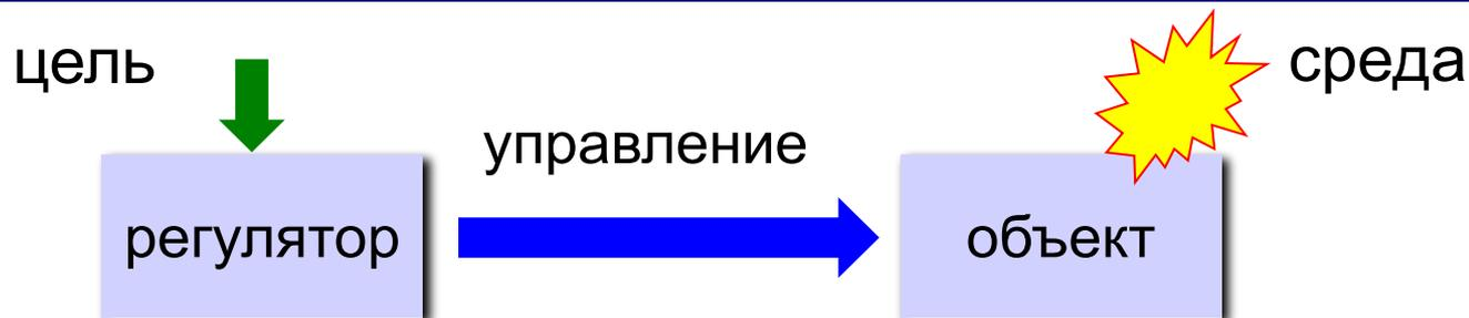
**Разомкнутая система** – регулятор не получает информации о состоянии объекта (*программное управление*).
