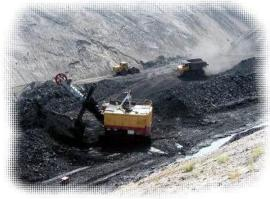
Существует два основных способа добычи угля: открытый и подземный. Там, где уголь залегает неглубоко, его добывают дешёвым открытым способом. Бачатский разрез в Кузбассе.
