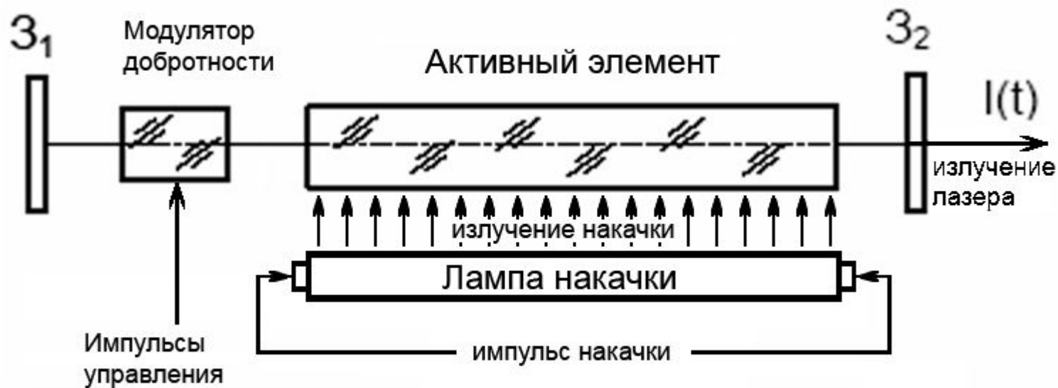
Схема лазера с активной модуляцией добротности резонатора
