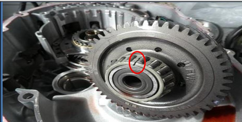
Неисправный подшипник(трещина) ведомой шестерни отбора
