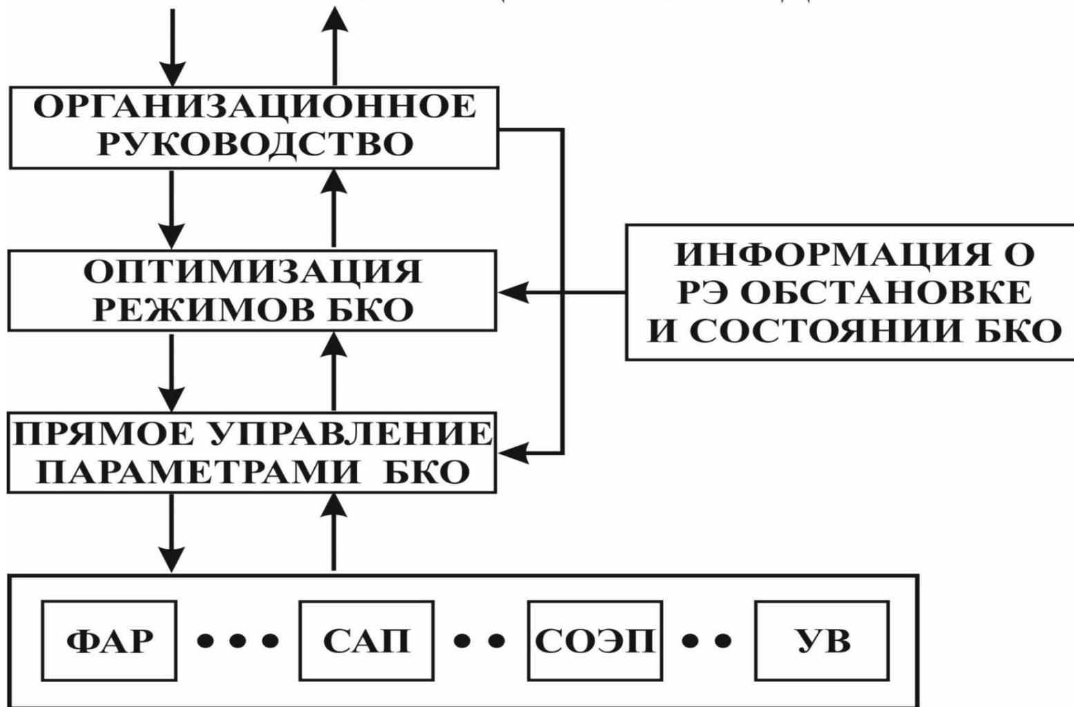
**Рис. 1.** Схема трехуровневой системы управления комплексом РЭБ
