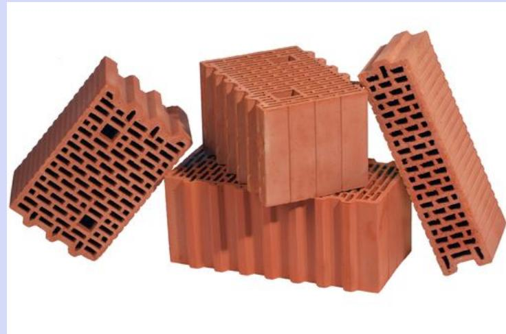
Пустотелые камни и кирпич применяют наравне со сплошным, за исключением кладки фундаментов, подземных частей стен, стен помещений с влажным режимом эксплуатации, печей и дымовых каналов.
