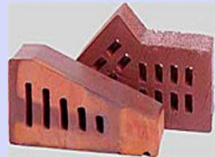
2) *Камни трапециoidalной формы* для кладки подземных коллекторов; клинкерный кирпич (дорожный) для мощения улиц, дорог, полов промышленных зданий, облицовки набережных.
