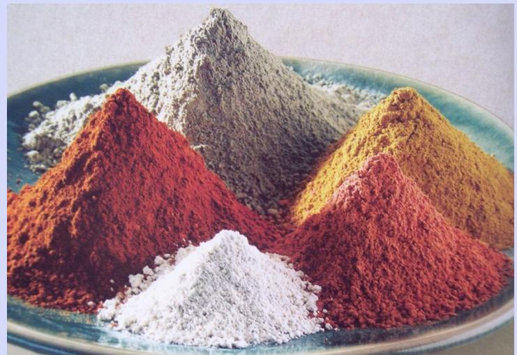
**ПРИГОТОВЛЕНИЕ ФОРМОВОЧНОЙ МАССЫ.** В зависимости от вида выпускаемой продукции и свойств исходного сырья формовочную массу получают в виде пластиичного глиняного теста, пресспорошков или шликера.
