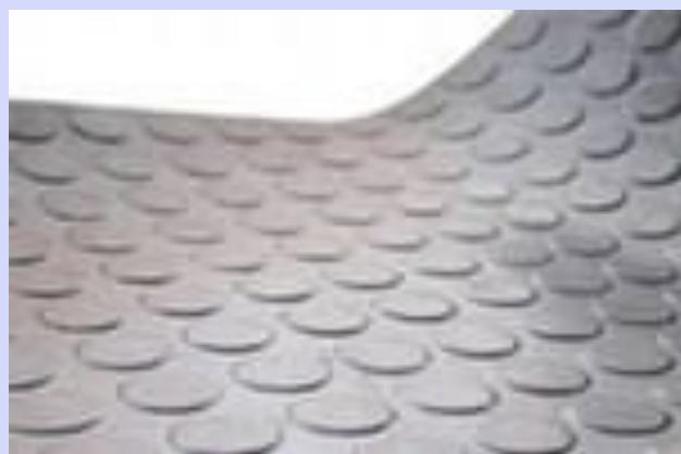
**Плитки для пола** размером 300Х300 мм толщиной 2...5 мм выпускают различного цвета, что позволяет выполнять мозаичные полы. Изготавливают их чаще всего на поливинилхлоридном полимере с наполнителями, пластификаторами и пигментами.
