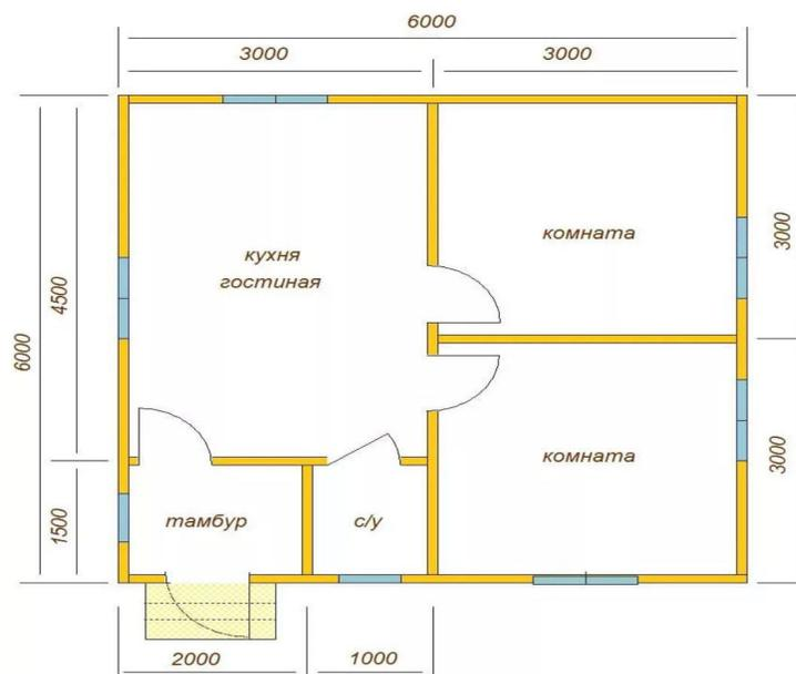
Толщина стен: 50 мм
