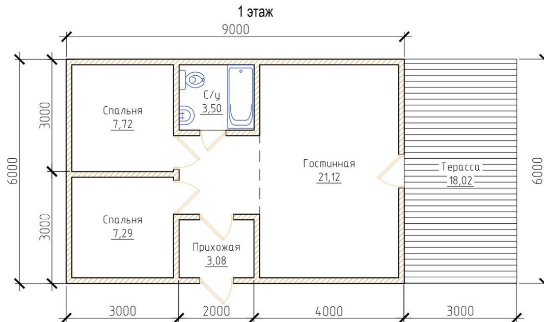
Толщина стен: 50мм
