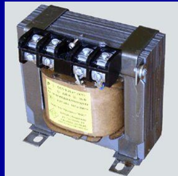
Рис. 22.3. Трансформатор с магнитопроводом броневого типа
