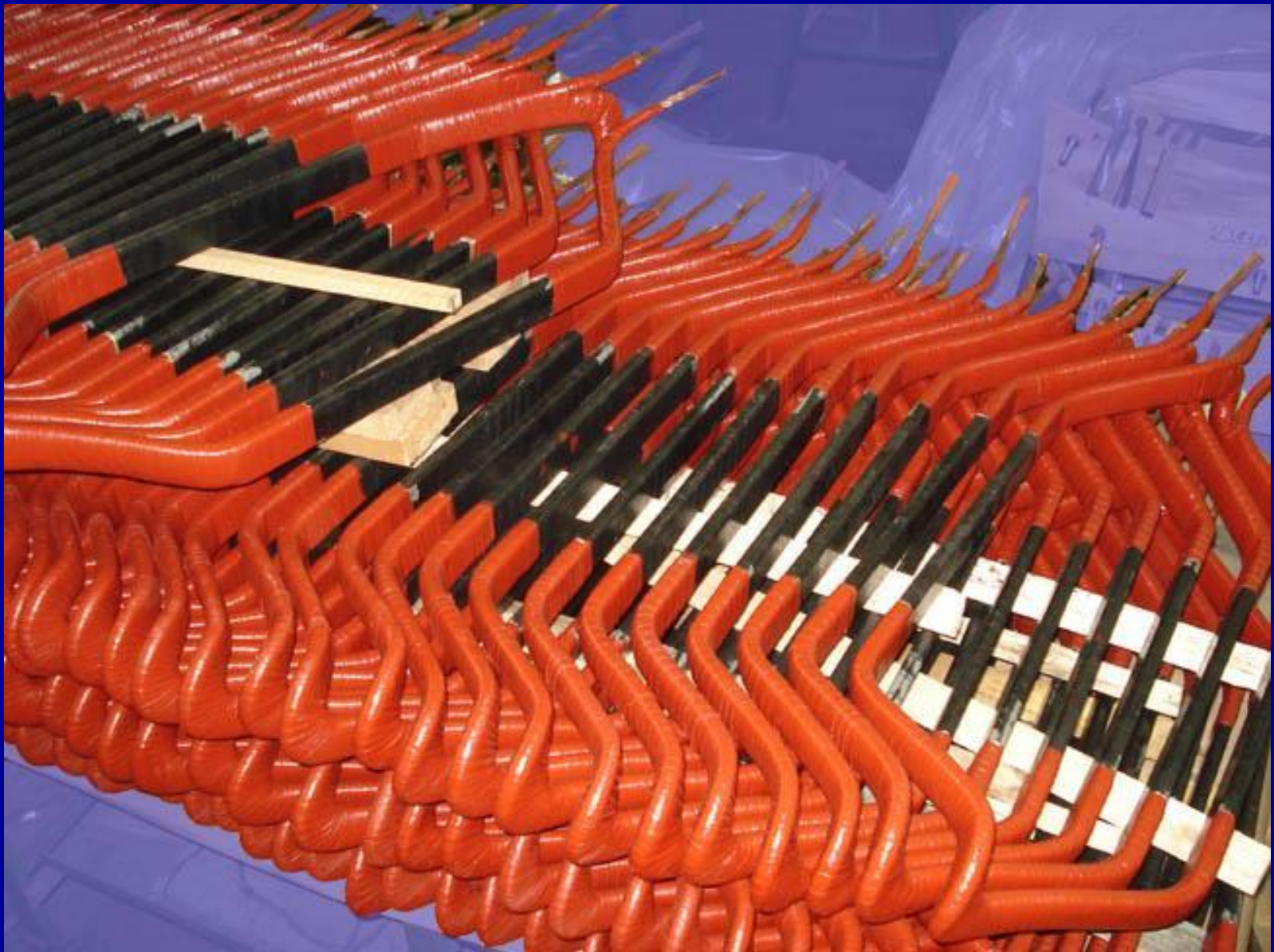
Изолированные секции обмотки электродвигателя
