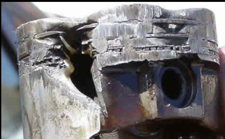
Расплавление поршня в следствии перегрева
