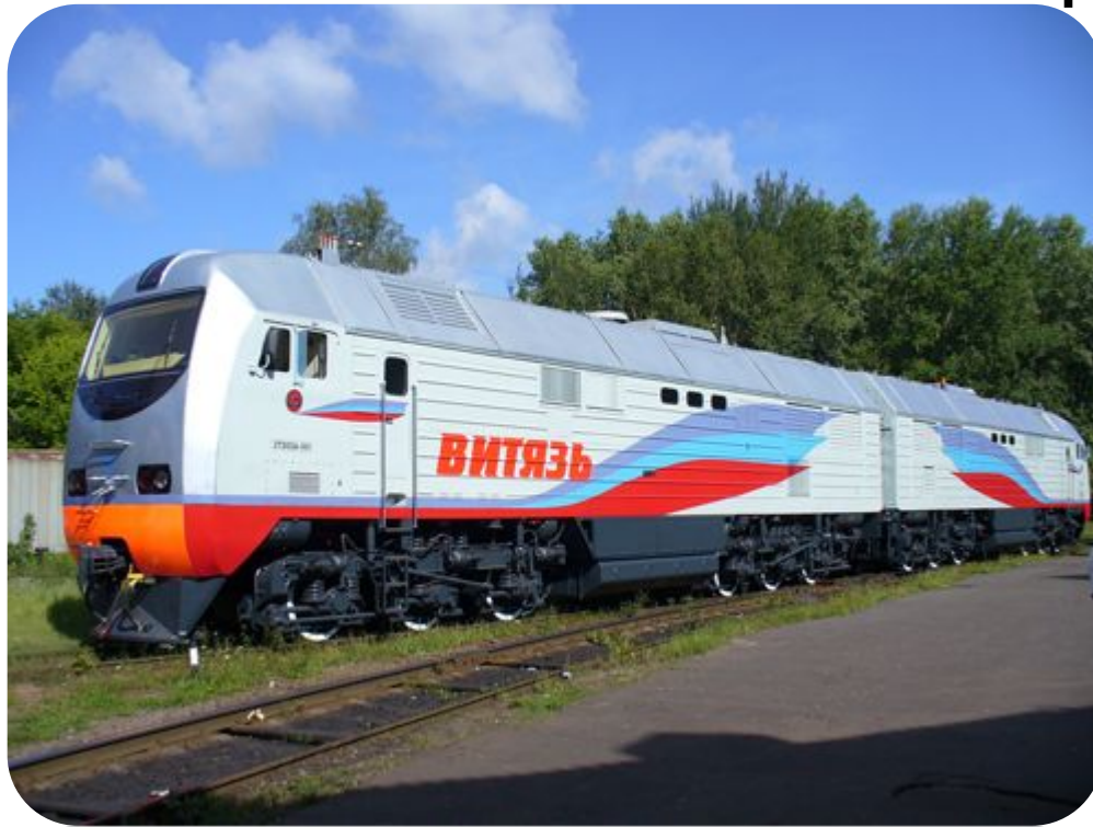
Двухсекционный тепловоз 2ТЭ25А
