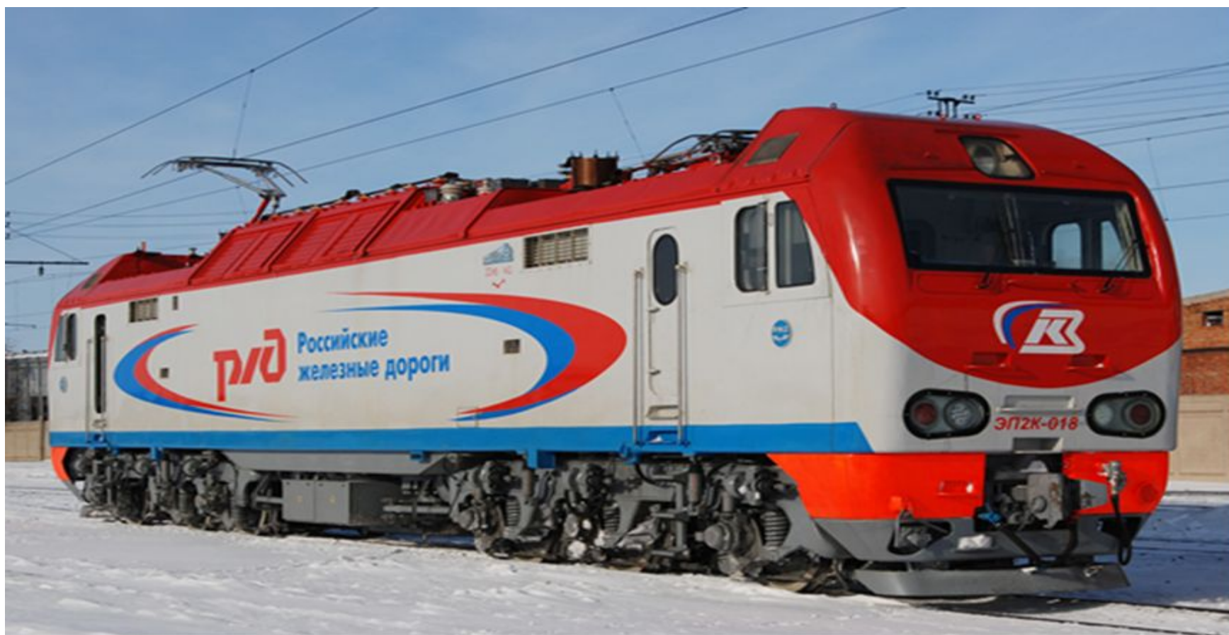
Электровоз ЭП2К ( Пассажирский, тип 2, Коллекторный тяговый привод)
