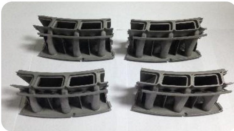
Элементы судового ГТД (сталь марки 07X18H12M2, аналог 316L)
